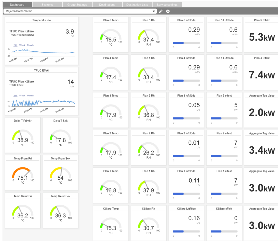
Bild: Användargränssnitt för mätning av klimat på byggarbetsplatsen, inne och ute
