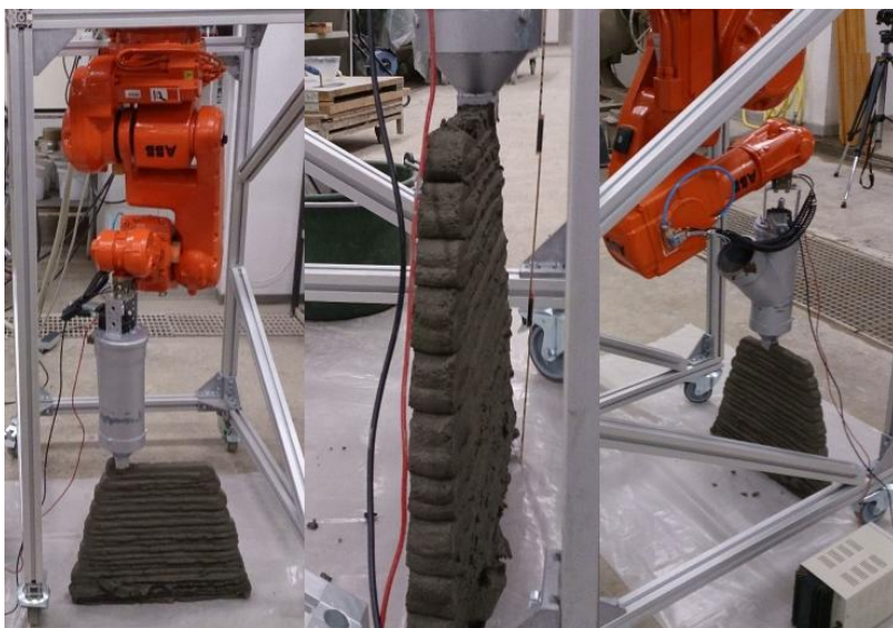
Figur 3: Exempel på munstycke hos 3D-skrivare anpassat till betong (Mikael Ehrensvärd Backebjörk, August Hamelius)
